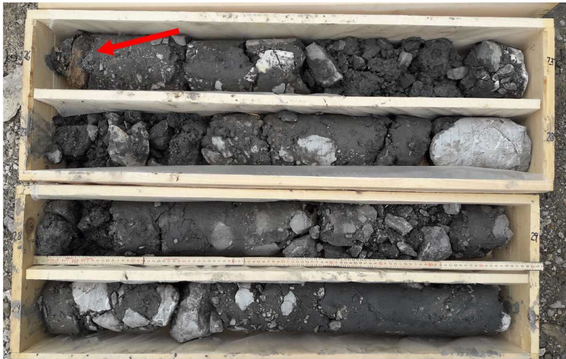
Abb. 7: Bohrkern der Schrägbohrung 2022 (26m bis 30m Tiefe) mit Holzstück (Pfeil)
